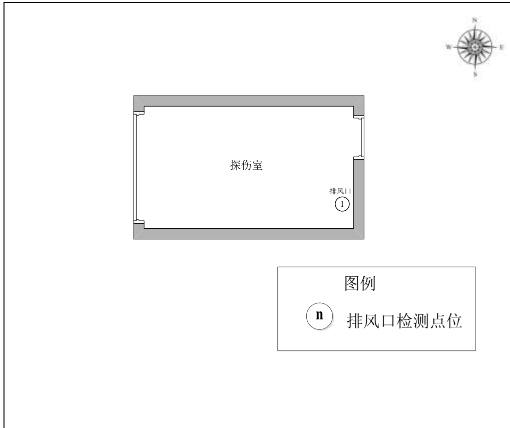
图 7-2 探伤室排风口风速监测布点图
