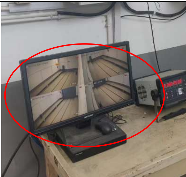
(b) 操作间内监控显示终端
