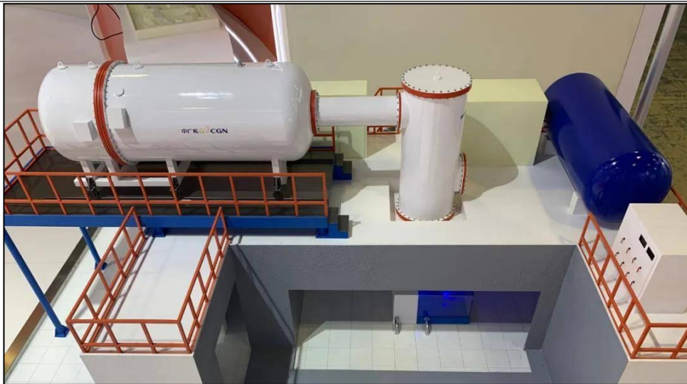
图 9-5 卧式半自屏蔽型电子加速器辐照装置外观示意图
